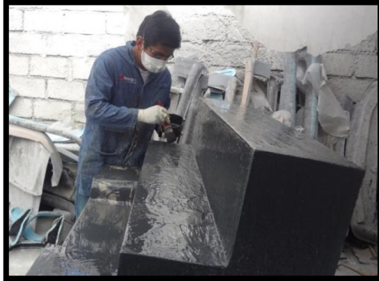
Figura 6-19 Aplicación de la primera mano con gelcoat.
