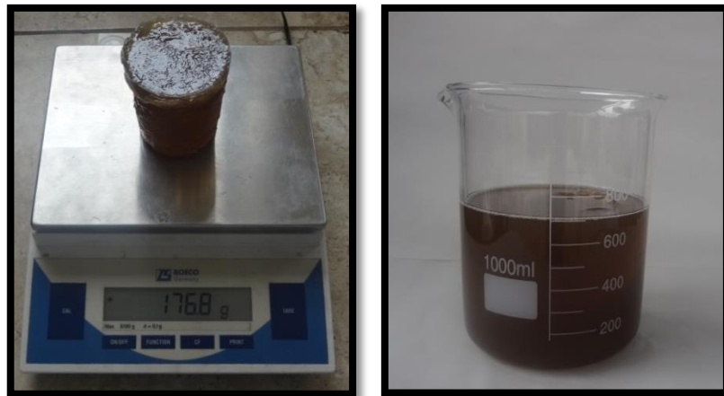
Figura 4-1 Determinación de la densidad de fibra de abacá.
