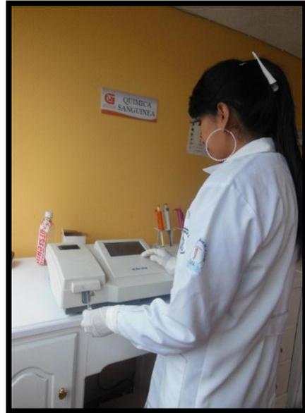
**Fotografía N.- 6** Determinación de creatinina en el equipo BA – 88A Semi-Automatizado para Química Clínica Marca Mindray
