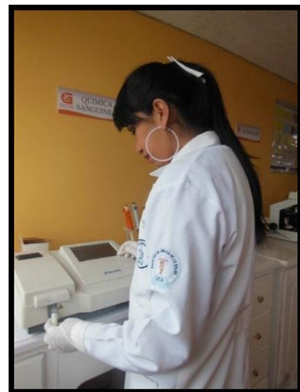
**Fotografía N.- 7** Determinación de microalbuminuria en el Espectrofotómetro: BTS 310-Biosystems.
