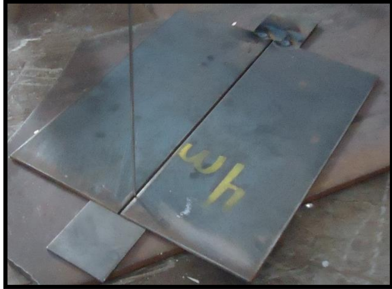
Gráfico 8-1 Juntas soldadas a TOPE ya FILETE
