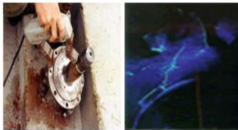
Gráfico 2-11 Ensayos por Partículas Magnéticas
