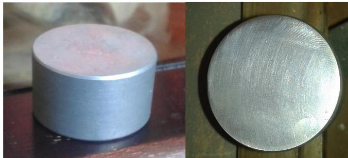
**Gráfico 6-5** Corte de probeta ZnAl para análisis metalográfico
