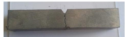
La probeta sometida al ensayo de impacto presenta rotura fragil.
