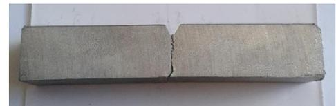
La probeta sometida al ensayo de impacto presenta fractura fragil.
