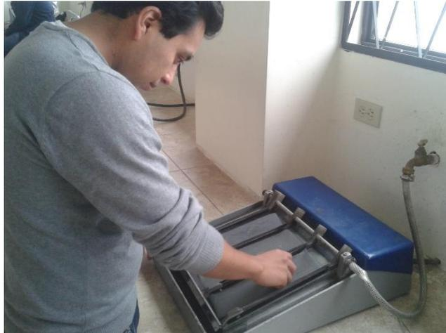
**Gráfico 6-6** Desbaste de probeta en el banco de lijas
