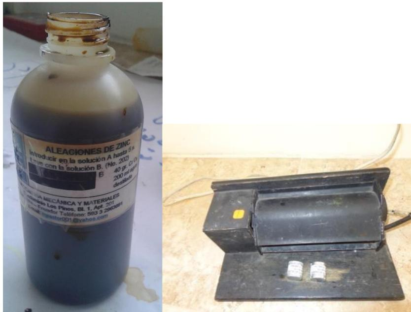
**Gráfico 6-8** Ataque químico y secado de probetas
