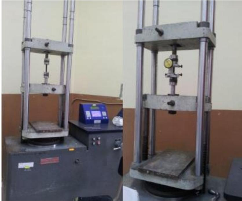
**Gráfico 2-13** Máquina de ensayos Universal Tinius Olsen capacidad 30 ton, empleada en ensayos de tracción. (Laboratorio FICM - UTA).
