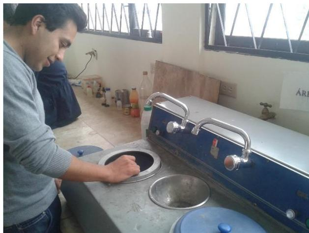
**Gráfico 6-7** Pulido de probetas
