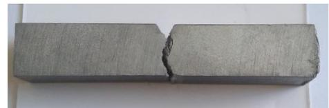
La probeta sometida al ensayo de impacto presenta fractura fragil.
