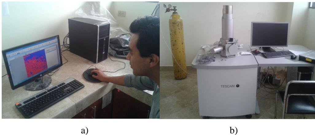
**Gráfico 6-10** Evaluación de la microestructura mediante software: a) Equipo de análisis metalográfico y b) Microscopio de barrido FICM –UTA
