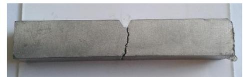
La probeta sometida al ensayo de impacto presenta rotura fragil.
