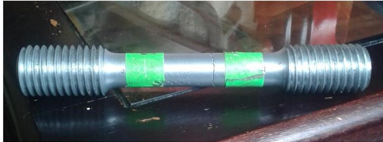
**Gráfico 6-4** Probeta maquinada para ensayo de tracción
