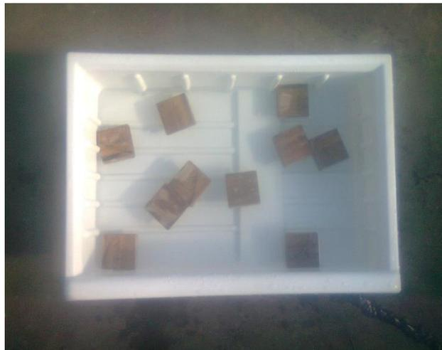
Figura 4-13 Probetas sumergidas en agua
