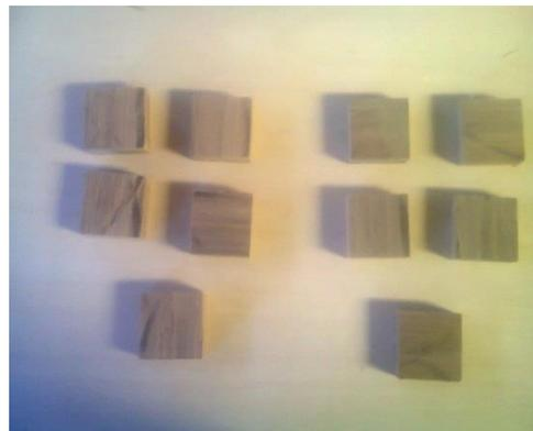
Probetas para ensayo de pegamento
