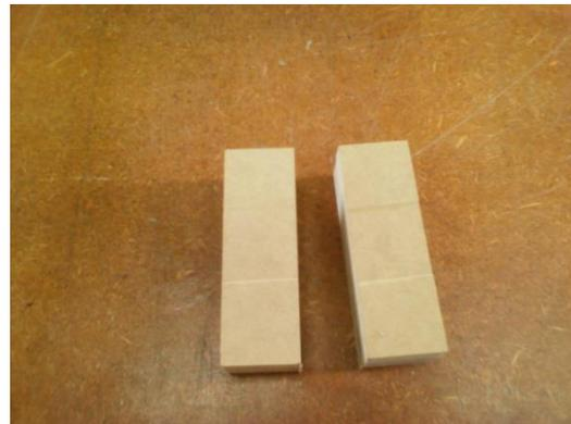
Probetas posterior al ensayo de compresión
