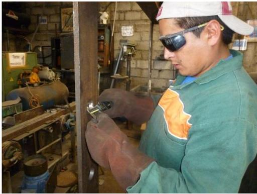
Medición del diámetro del eje
