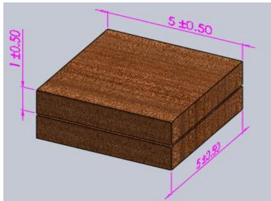
Figura 4-12 Probetas para ensayos de adhesivos
