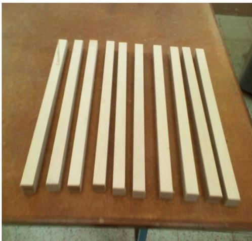
Probetas para ensayos a flexión
