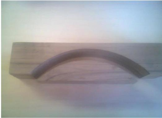
Molde con radio de curvatura 200 mm
