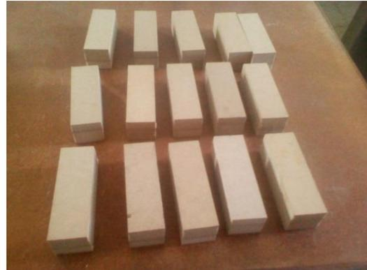
Probetas para ensayos a compresión
