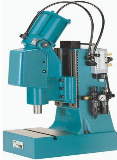
Figura 6-3 Prensa neumática
