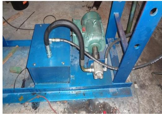
Instalación de mangueras de presión
