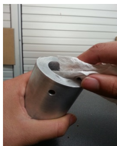
Figura 6.19 Limpieza del molde. Fuente: Pablo Tirado.
