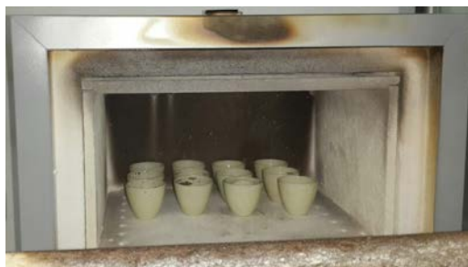
Figura 4.15 Muestras de briquetas en horno de mufla Fuente: Laboratorio de Control y Análisis de Alimentos (LACONAL).
