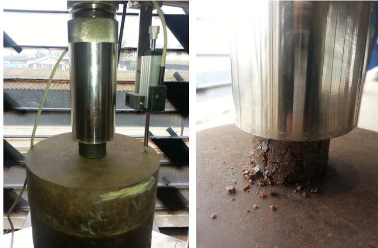
Figura 4.23 Aplicación de carga en briquetas formadas a presión de 500 \text{ kg/cm}^2 y temperatura de 170 \text{ }^\circ\text{C} .
