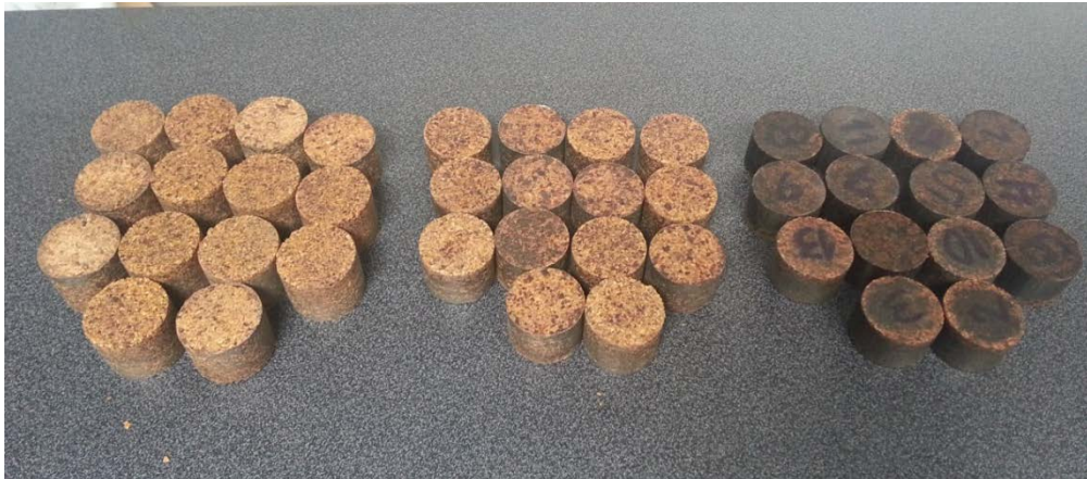
Figura 4.19 Briquetas para el ensayo de resistencia al aplastamiento. Fuente: Pablo Tirado.
