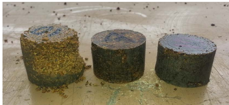
Figura 4.24 Briquetas luego del ensayo de resistencia al aplastamiento.
