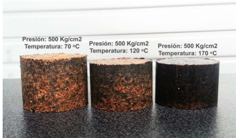
Figura 4.9 Briquetas compactadas a diferentes temperaturas. Fuente: Pablo Tirado.
