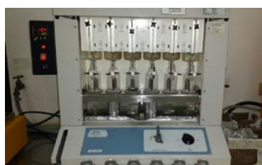
Figura 4.17 Extracción de grasa de las briquetas.
