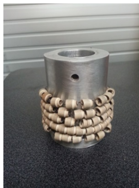
Figura 6.28 Colocación de la niquelina. Fuente: Pablo Tirado.
