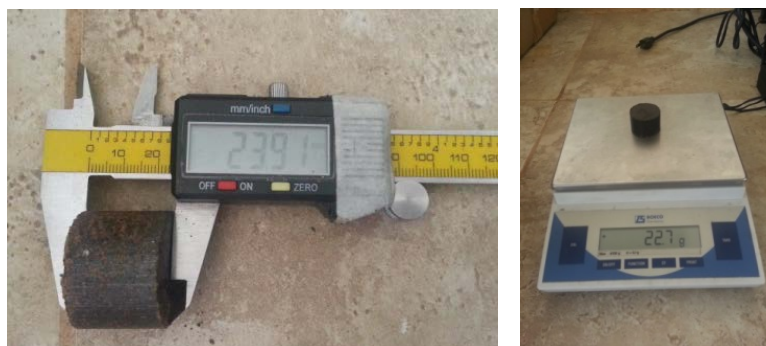
Figura 4.13 Determinación de la densidad de las briquetas.
