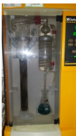
Figura 4.16 Digestión de la proteína de las briquetas. Fuente: Laboratorio de Control y Análisis de Alimentos (LACONAL).
