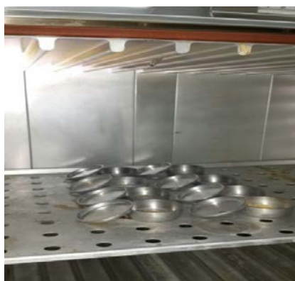
Figura 4.14 Muestras de briquetas en la estufa a temperatura de 105°C.
