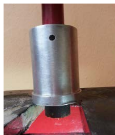
Figura 6.34 Desmolde de la briqueta. Fuente: Pablo Tirado.
