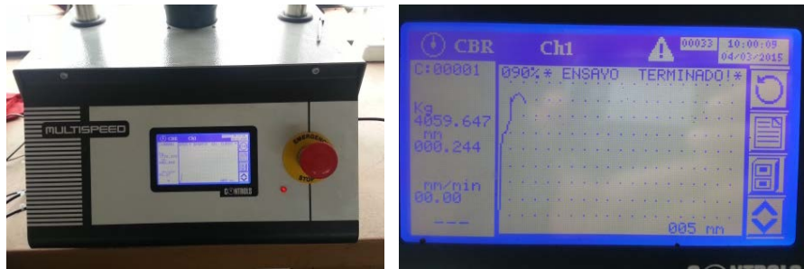
Figura 4.20 Lectura de la carga aplicada en las briquetas Fuente: Pablo Tirado.
