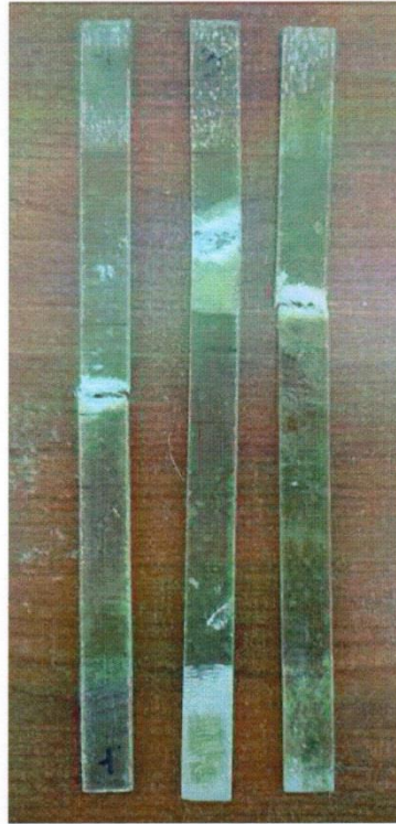
Figura 2. Probetas de matriz poliéster con refuerzo de fibra de vidrio después de las pruebas de tracción.
