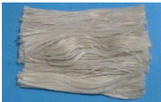
Figura 4.29. Fibra de piña libre de impurezas.
