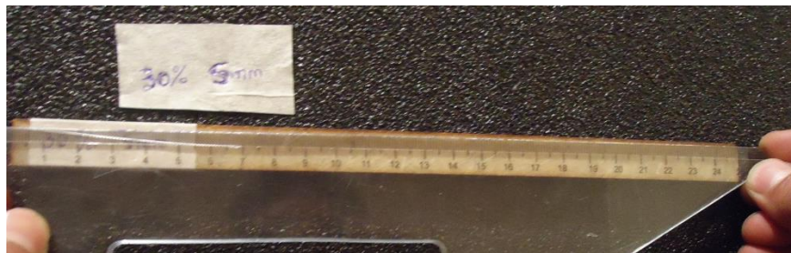
Figura 4.54. Comprobación de la longitud de la probeta para ensayo a tracción. (Fuente: Realizada por el autor).
