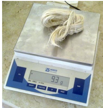
Figura 4.18. Determinación de densidades de la fibra por método gravimétrico. (Fuente: Realizada por el autor).
