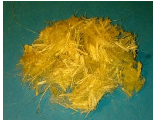
Figura 4.22. Fibra de piña de 10mm.
