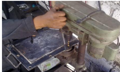
Figura 4.8. Construcción de la tapa del molde.
