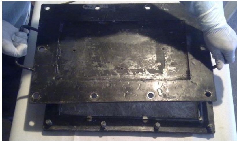
Figura 4.39. Sellado del molde. (Fuente: Realizada por el autor).
