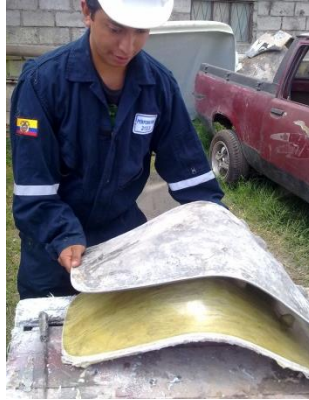
Desmolde prototipo de butaca deportiva.
