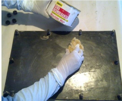
Figura 4.26. Aplicación de cera desmoldante en la base del molde. (Fuente: Realizada por el autor).
