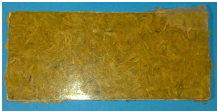
Figura 4.46. Material compuesto con fibra de piña de 10mm. (Fuente: Realizada por el autor).
