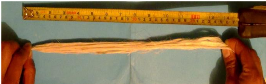
Figura 4.23. Fibra larga longitudinal.
