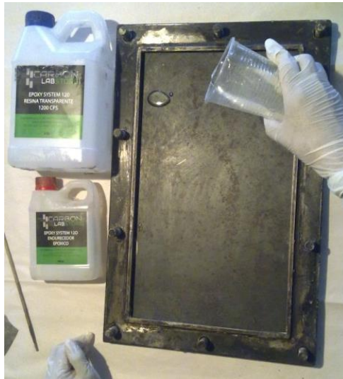
Figura 4.35. Vertido de resina epoxi sobre el molde. (Fuente: Realizada por el autor).
