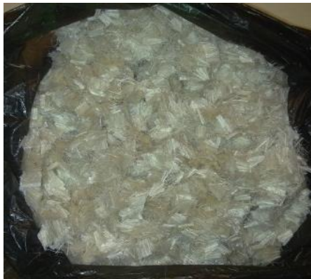
Figura 4.21. Fibra de piña de 5mm.
