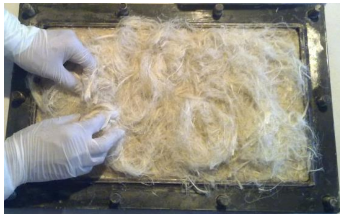
Figura 4.36. Mezcla del material compuesto (resina epoxi + fibra de piña). (Fuente: Realizada por el autor).
