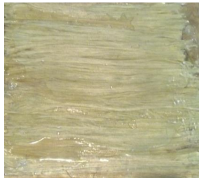
Figura 4.38. Resina epoxi + fibra de piña.
