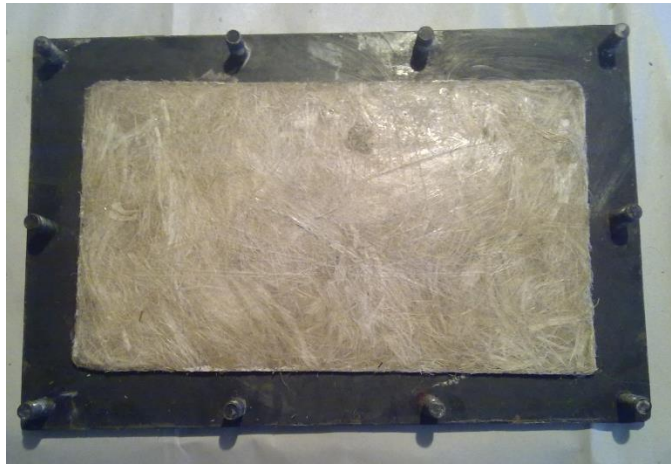
Figura 4.14. Desmolde. (Fuente: Realizada por el autor).
