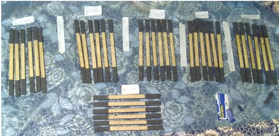
Figura 4.62. Probetas para ensayo a tracción con cintas de adherencias.
