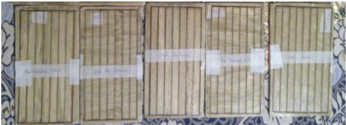
Figura 4.55. Probetas para ensayo a Flexión (cortadas bajo la Norma ASTM D7264-07).
