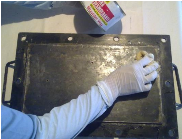
Figura 4.28. Aplicación de cera desmoldante en la tapa del molde.
