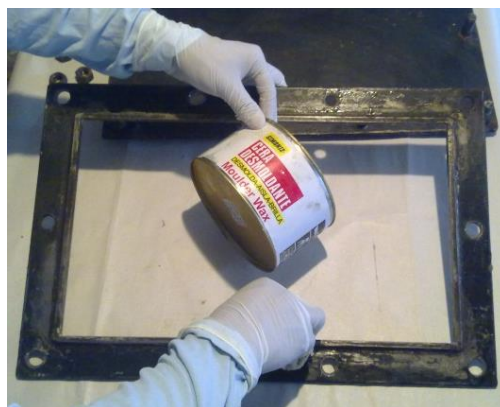
Figura 4.27. Aplicación de cera desmoldante en el cuadro del molde. (Fuente: Realizada por el autor).
