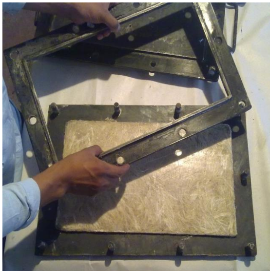
Figura 4.43. Desmonte del cuadro de moldeo.
