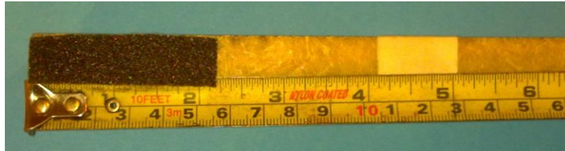
Figura 4.61. Colocación de cintas de adherencias.
