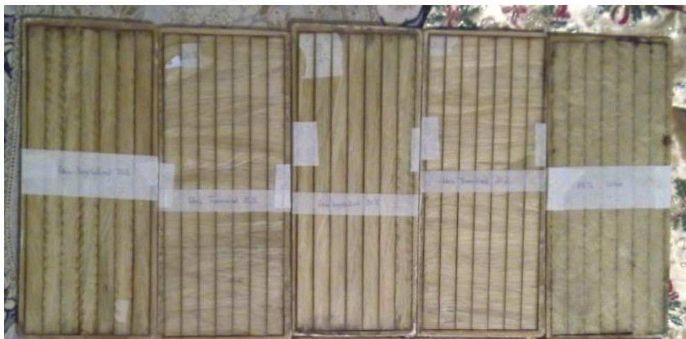
Figura 4.51. Probetas para ensayo a tracción (cortadas bajo la Norma ASTM D3039-14).
