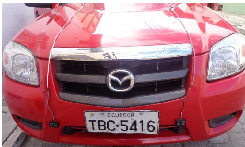
Fig. 4.32 Instalación de los sensores en la parte delantera del vehículo Fuente: Investigador
