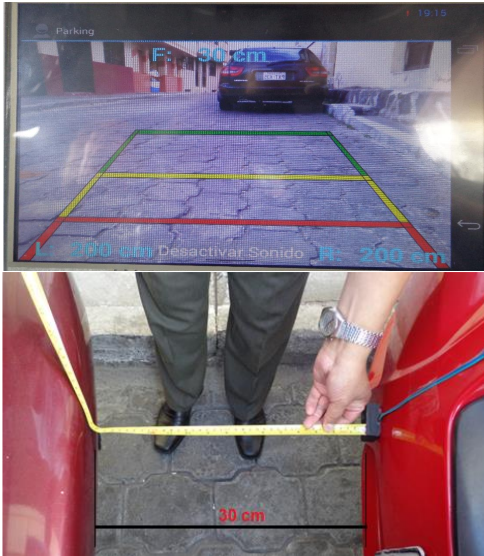
Fig. 4.39 Vehículo a 30 cm de distancia de otro en la parte delantera Fuente: Investigador
