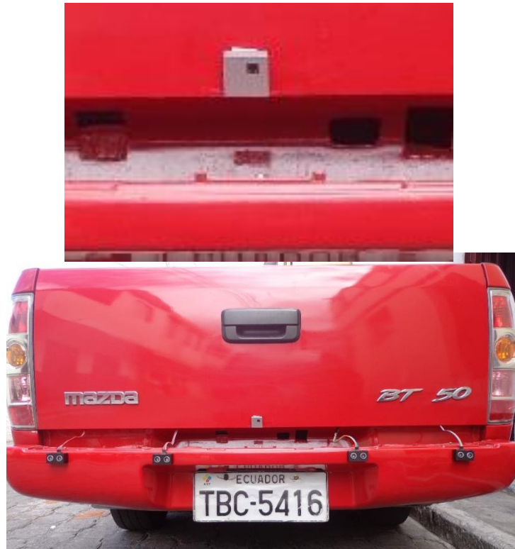
Fig. 4.31 Instalación de los sensores y de la cámara en la parte trasera del vehículo Fuente: Investigador
