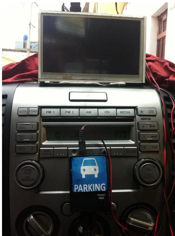
Fig. 4.33 Instalación de la pantalla y del interruptor para el encendido del sistema de estacionamiento Fuente: Investigador
