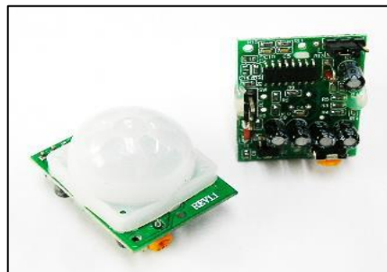
Fig. 3: Sensor de Movimiento PIR DYP-ME003
