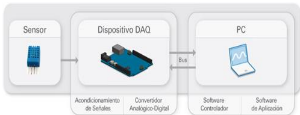
Fig. 1: Partes de un Sistema DAQ
