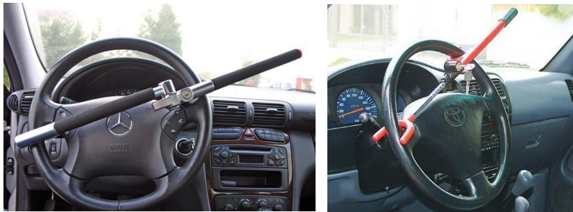
Figura 2. 2 Mecanismo de Bloqueo que impide giro de volante [13]
