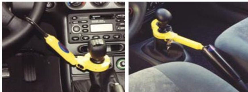
Figura 2. 3 Mecanismo de Bloqueo que interrumpe funciones de la palanca de cambios [13]
