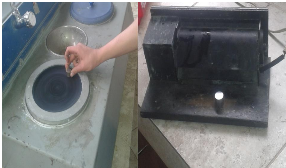
Figura 6.16. Pulido y secado de Probetas
