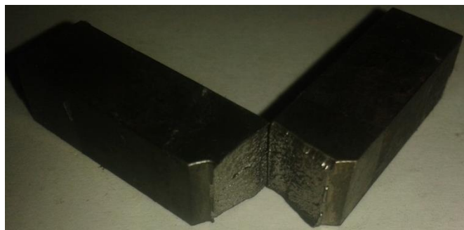
Figura 6.13. Detalle de Ruptura acero AISI 4140
