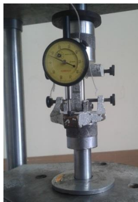
Figura 6.9. Deformación controlada en la maquina universal
