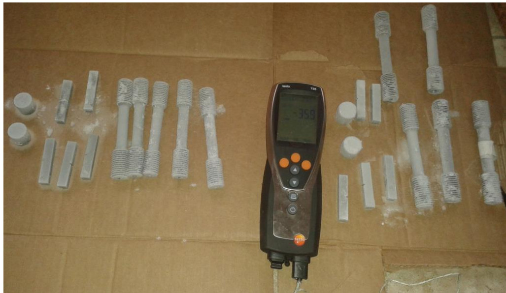
Figura 6.7. Calentamiento de probetas hasta temperatura ambiente
