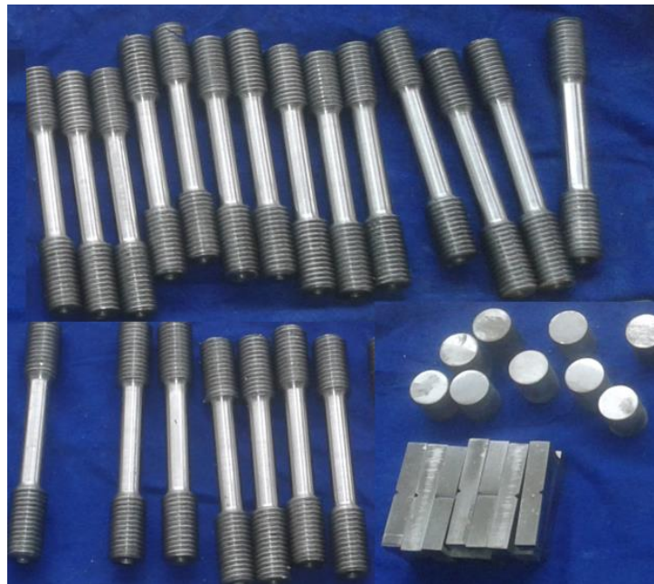
Figura 6.2. Probetas para todo los ensayos elaboradas bajo normas específicas
