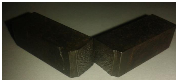
Figura 6.12. Detalle de Ruptura acero AISI 1045
