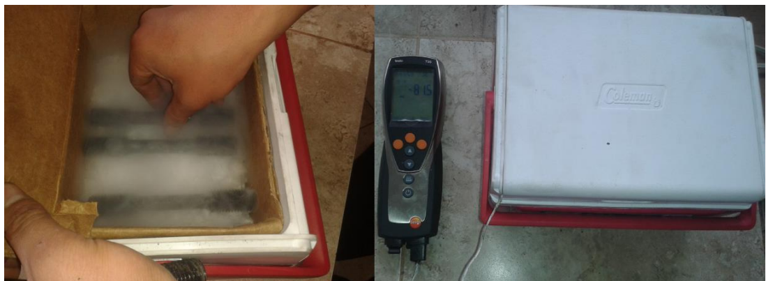
Figura 6.6. Sumergimiento en CO 2 para el tratamiento Sub-cero.
