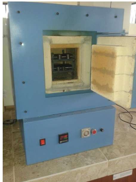
Figura 6.8. Probetas en el horno térmico para el tratamiento de revenido
