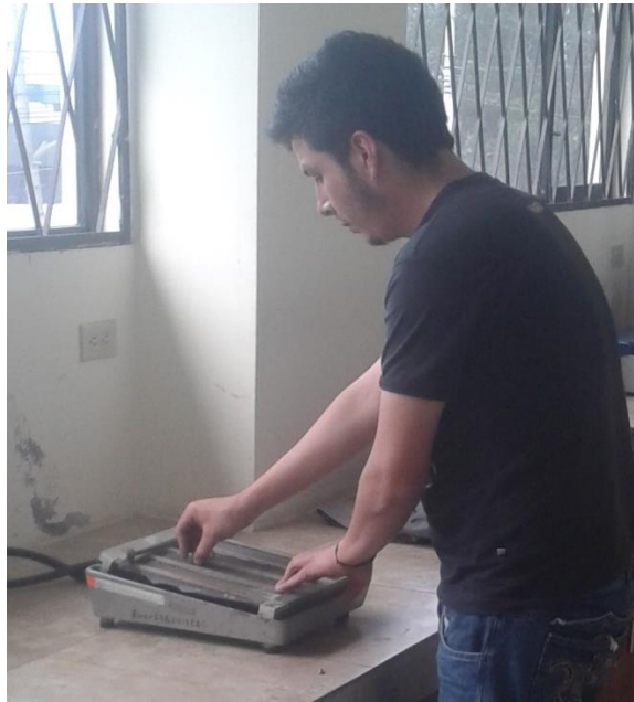
Figura 6.15. Desbaste superficial de muestras metalográficas
