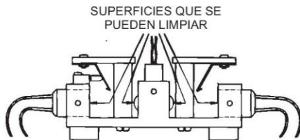
Figura 1. Limpieza de las superficies ópticas
