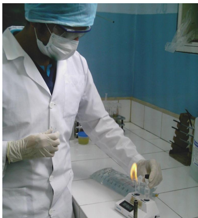
Gráfico 38. Equipo Turbidimétrico utilizado, control del equipo frente a escala 0,5 de McFarland Fuente: Investigación de campo
