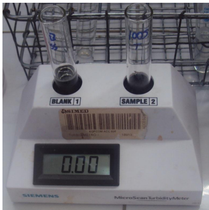
Gráfico 37. Equipo Turbidimétrico utilizado, control del equipo frente a solución salina. Fuente: Investigación de campo
