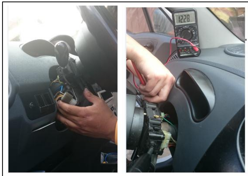
Fig. 4.30 Señal de las luces del vehículo Elaborado por: El Investigador
