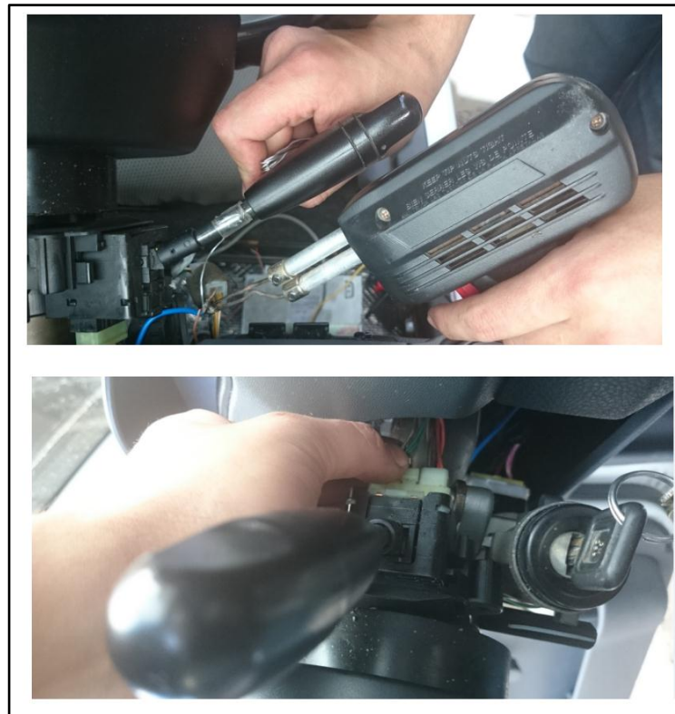
Fig. 4.33 Señal del Foco del encendido y apagado del Auto Elaborado por: El Investigador
