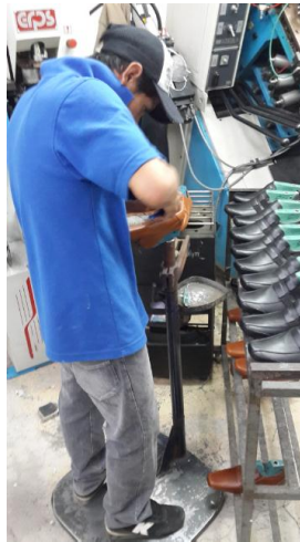
Figura 40. Armado de costados
