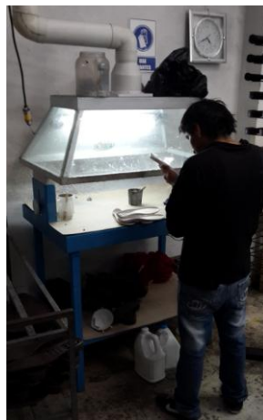
Figura 50. Mesa de trabajo para preparado de suelas
