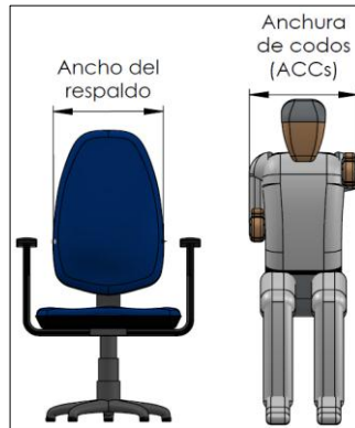
Figura 99. Relación dimensional del ancho del respaldo del asiento
