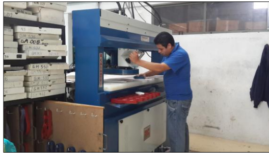
Figura 19. Área de troquelado de plantillas
