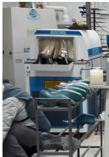
Figura 55. Enfriado de calzado
