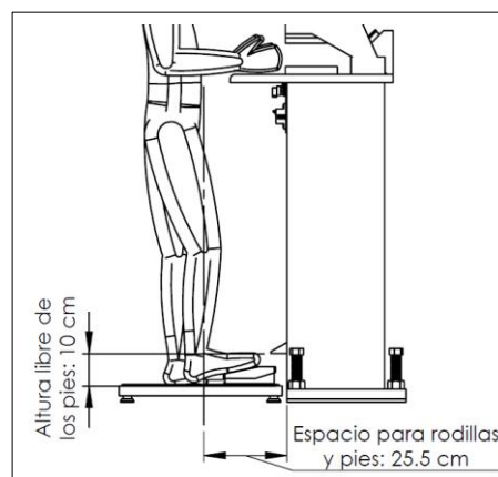
Figura 145. Espacio recomendado para las extremidades inferiores en la reactivadora de puntas
