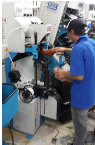
Figura 41. Armado de talones
