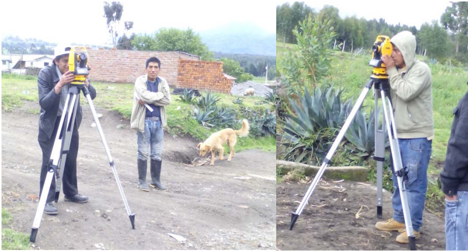
Fotografía 4.- Manejo de la estación total
