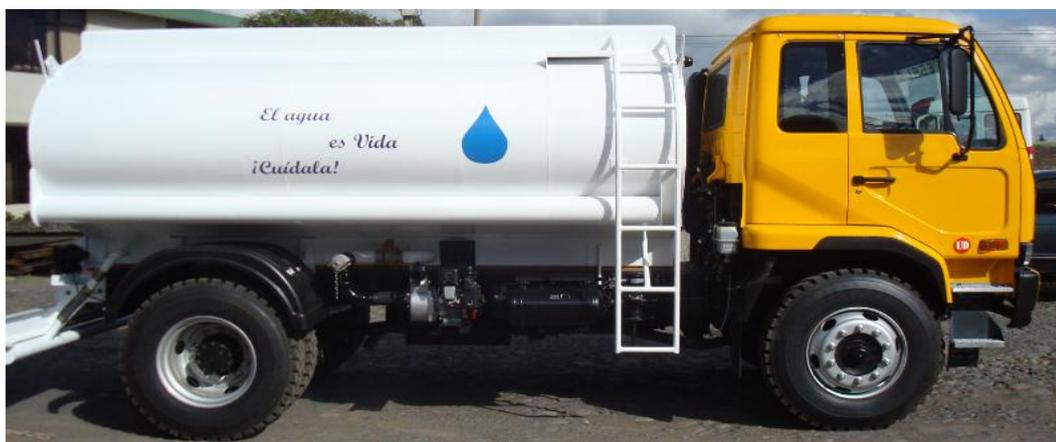
**Figura 2.3:** Tanque Montado de 2000 Galones, 1 compartimentos con bomba de succión (Fotos de propiedad de la empresa Construcciones Ulloa).
