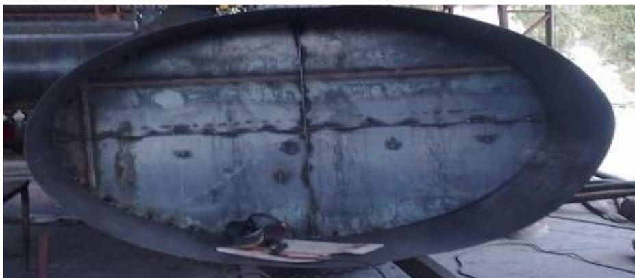
**Unión de los espejos y rollos de para el armado de un tanque**
