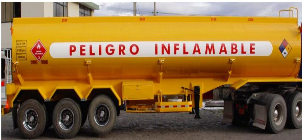
**Figura 2.4: Tanques Semirremolques de 10000 Galones 4 compartimentos (2500 cada una) (Fotos de propiedad de la empresa Construcciones Ulloa).**
