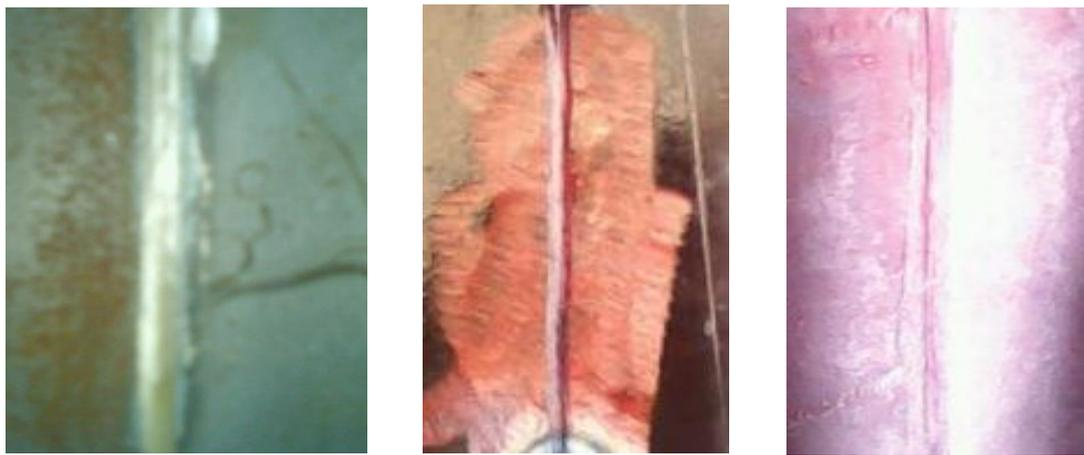
**Fig. 4.12: (a) Soldadura preparado de bisel (b) Aplicación del Penetrante (c) Aplicación del revelador (elaborado por el investigador).**
