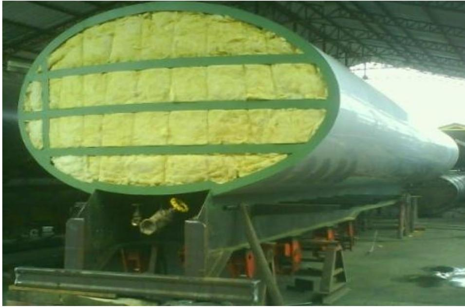
**Forrado de un tanque térmico**
