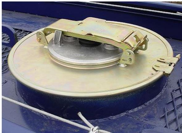
**Figura 2.6: Entrada pasa - hombre para los Tanques (Fotos de propiedad de la empresa Construcciones Ulloa).**
