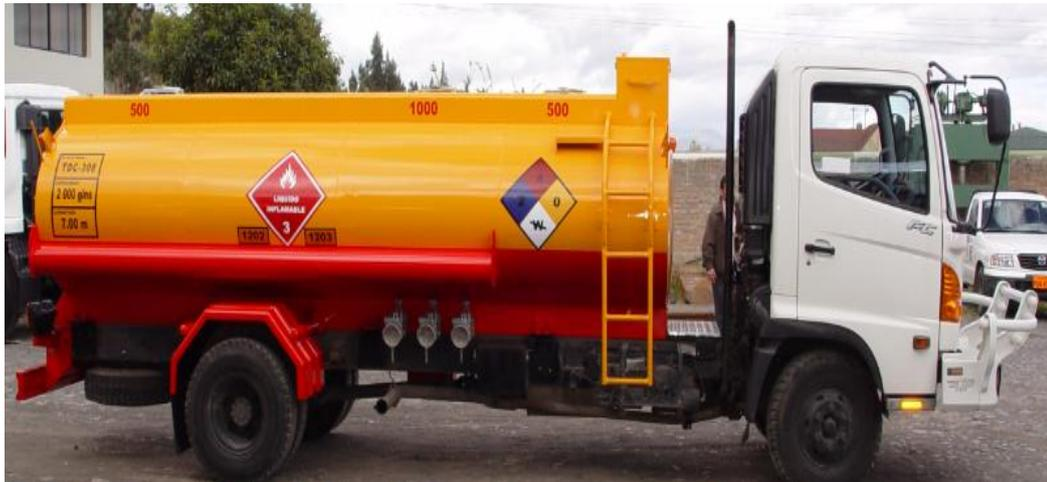
**Figura 2.2:** Tanque Montado de 2000 Galones, 3 compartimentos (1000 – 500 – 500 respectivamente) (Fotos de propiedad de la empresa Construcciones Ulloa).
