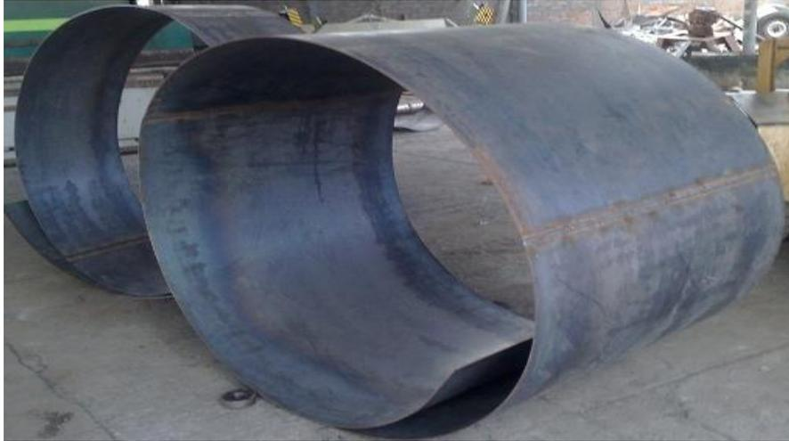
**Rollos para el armado del cuerpo del tanque**
