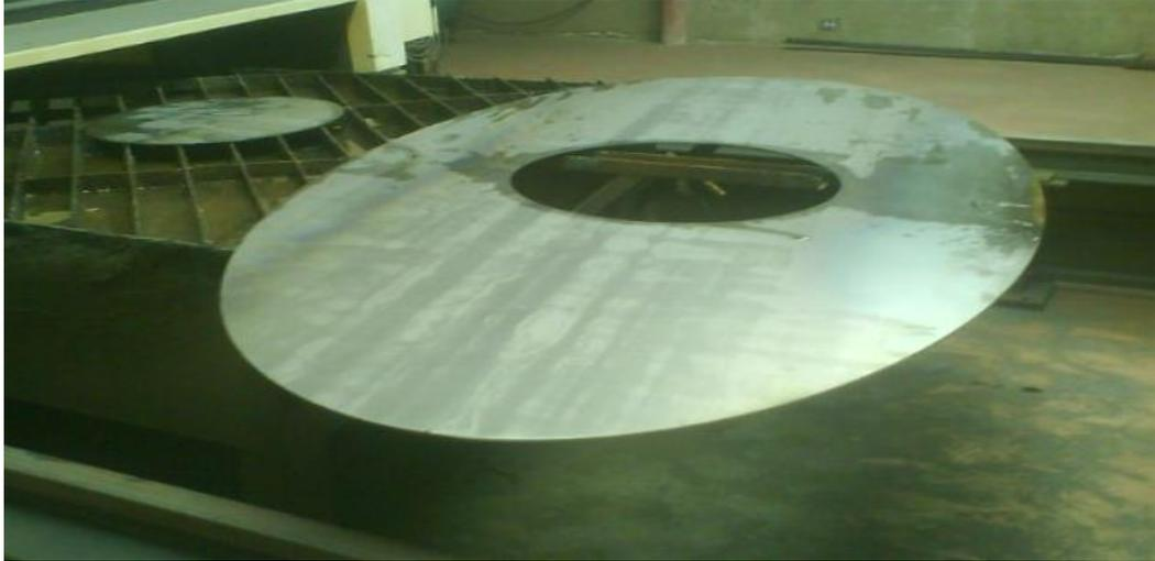
**Figura 2.16: Espejo o Rompeolas cortado con el plasma CNC LINEACORD 20-TD.**
