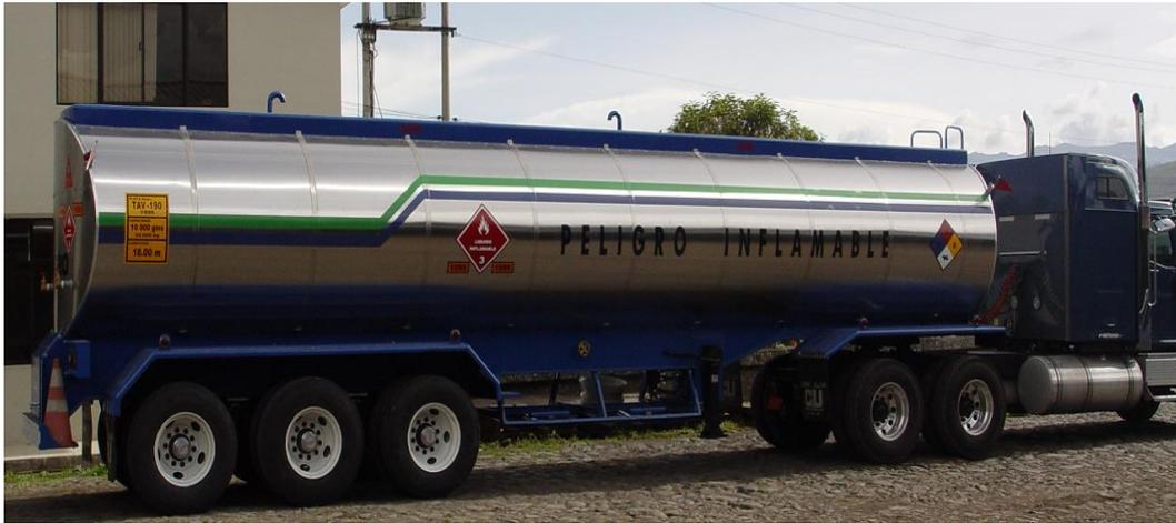
**Figura 2.5: Tanque Térmico de 10000 Galones de 1 compartimento (Fotos de propiedad de la empresa Construcciones Ulloa).**
