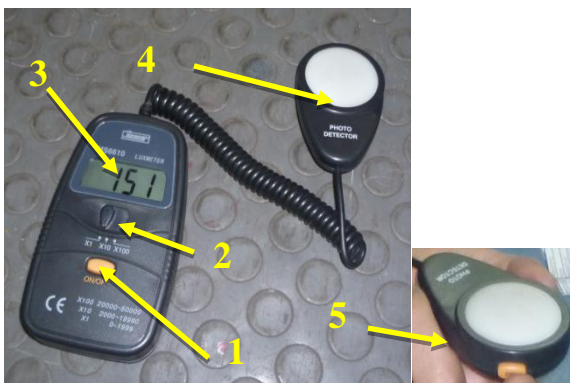
Fig. 35. Luxómetro SENCO MS6610
