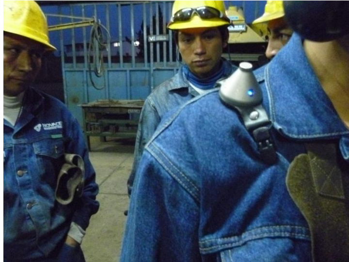
Fig.6.6.Ubicación del micrófono del Dosímetro (doseBadge CR: 100B)
