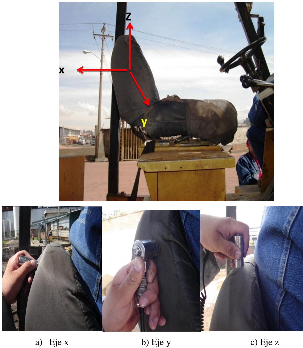
Fig.6.28. Montacargas 1 Caterpillar 150 (sobre el espaldar del asiento del operador)
