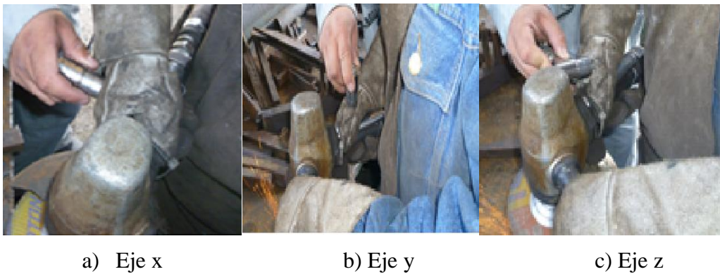
Fig.6.25. Amoladora Neumática(Medición Basidinámica mano derecha)
