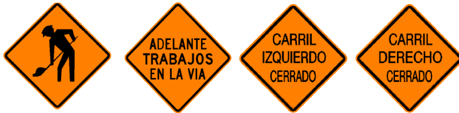
Gráfico N° 51. Señales para trabajos en la vía o propósitos especiales
