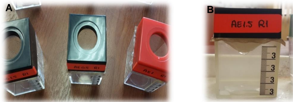
Figura 19. Resistencia al agua según el método descrito por Blanco-Pascual et al. (2013). A: Recipiente + muestras (películas). B: Filtración de agua.
