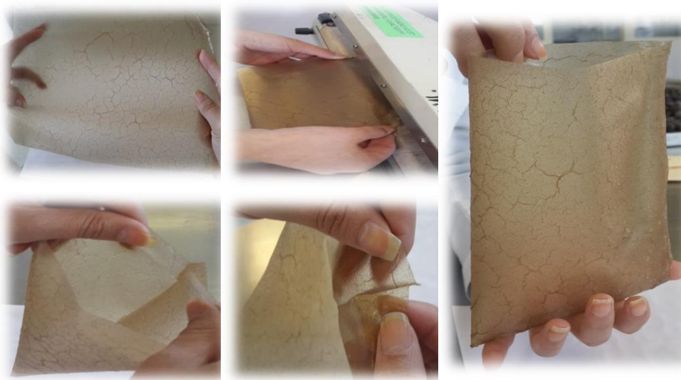
Figura 27. Elaboración de las fundas biodegradables activas, utilizando la técnica desellado por impulso.
