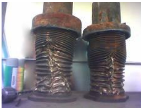
Figura 2.8 Material destruido por un "golpe de ariete".
