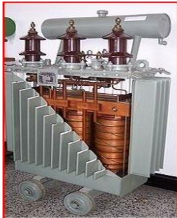
Figura 2.9 Transformador de núcleo laminado (corte)
