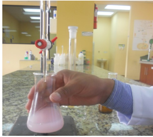
Fotografía E-2: Determinación de acidez
