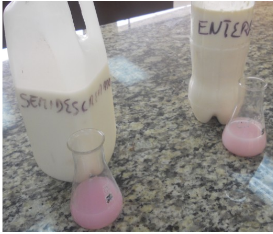
Fotografía E-1: Determinación de acidez
