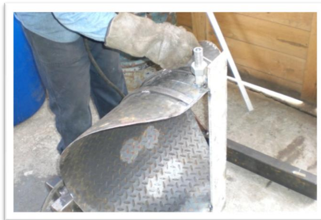
Fig. 6.31. Colocación del eje.
