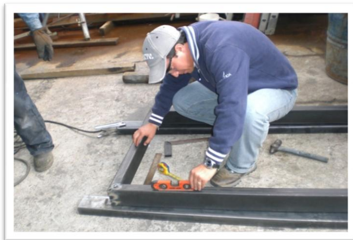
Fig. 6.18. Nivelación para Soldadura del Chasis.
