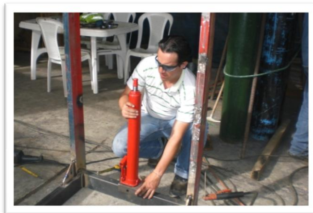
Fig. 6.29. Colocación del Gato en el Chasis.
