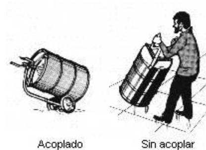
Fig. 2.3: Estructura metálica con sujeta bidones
