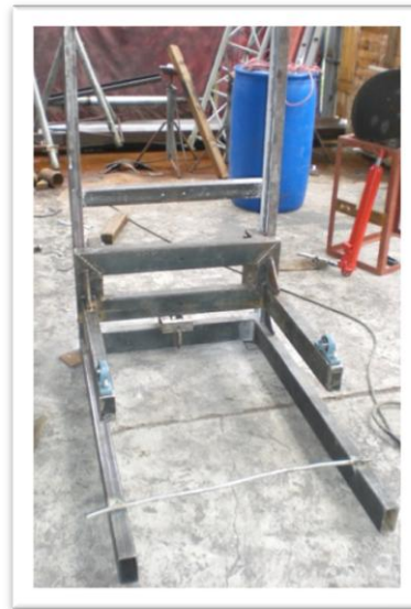
Fig.6.35. Mastil y Horquillas posecionadas.
