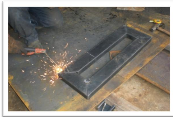
Fig. 6.23. Soldadura en el Cuadrante.
