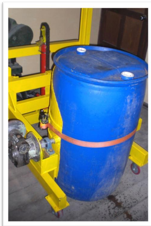
Fig. 6.47. Tanque en posición inicial ya vaciado.
