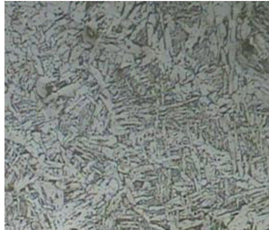
Acero A36 Cordón de soldadura 100x_Nital4_6s (Resina Poliéster)
