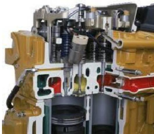
**FIGURA 2.2. Corte de un motor Caterpillar C-15.**
