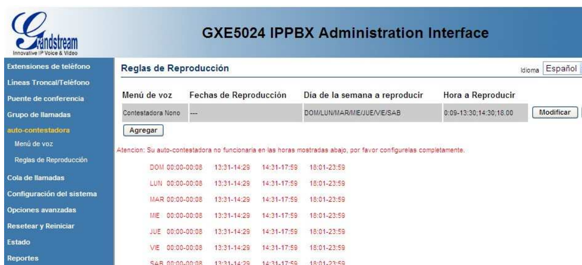
Figura 6.30. Condiciones de funcionamiento de la contestadora automática
