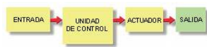
Figura 2.2 Esquema del sistema de control en lazo abierto.
