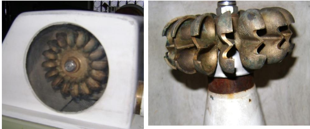
Turbina Pélton en mal estado.
