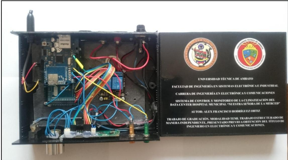
Figura 4.33: Vista Conexión de cableado interno superior
