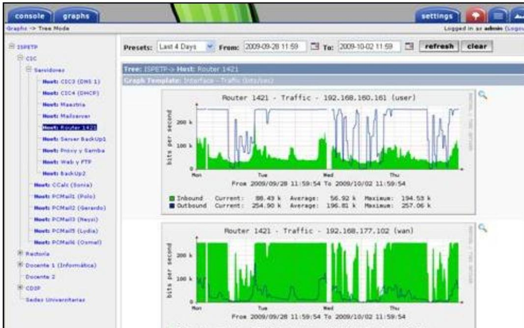
Figura 2.4: Monitoreo basado en el protocolo SNMP-CACTI
