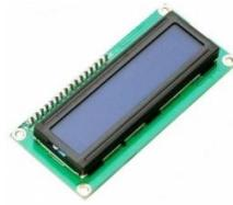
Figura 4. 9 Módulo LCD 16X2
