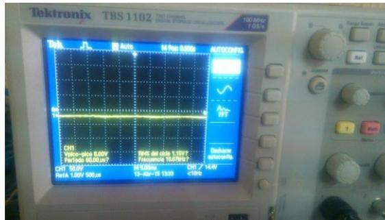
Figura 4. 43 Ángulo de conducción a 180 grados
