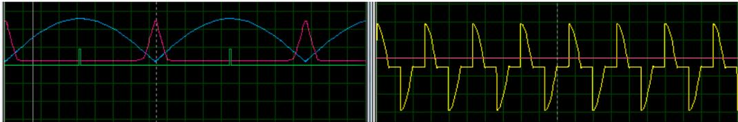
Figura 4. 29 Formas de ondas, ángulo de disparo y ángulo de conducción 90-90(grados)
