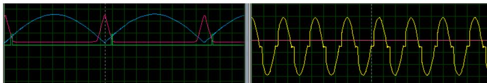
Figura 4. 27 Formas de ondas, ángulo de disparo y ángulo de conducción 0-180(grados)
