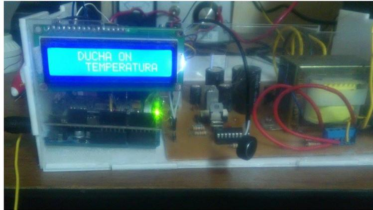
*Figura 4. 48 Visualización de estados en la pantalla LCD*
