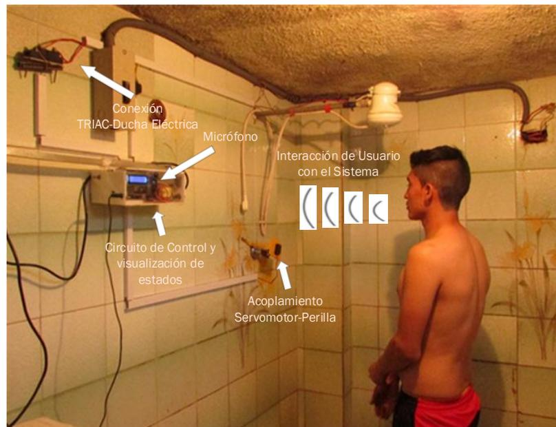
Figura 4. 49 Pruebas de funcionamiento
