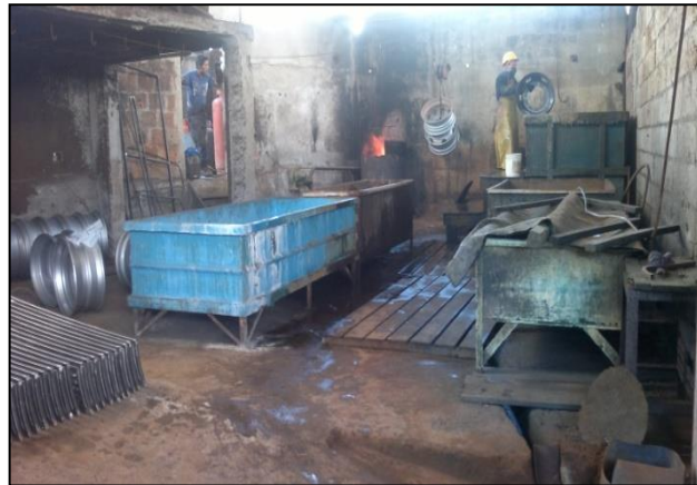
Figura 30. Lavado de piezas posterior al proceso de decapado.
