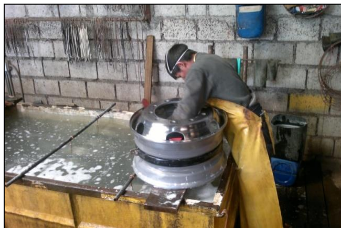
Figura 35. Lavado posterior al desengrase catódico
