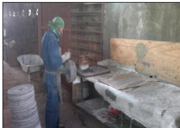
Figura 31. Elaboración de los discos para el pulido.
