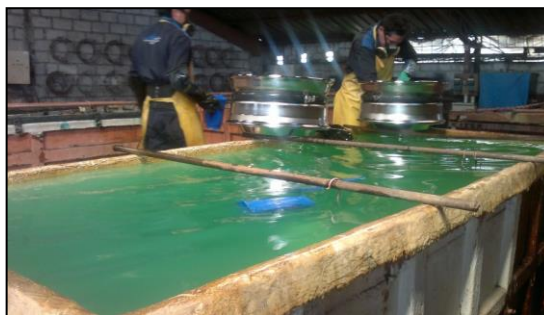
Figura 38. Lavado de recuperación posterior al baño de níquel
