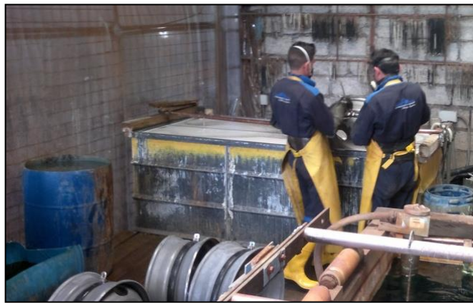
Figura 34. Proceso de desengrase catódico
