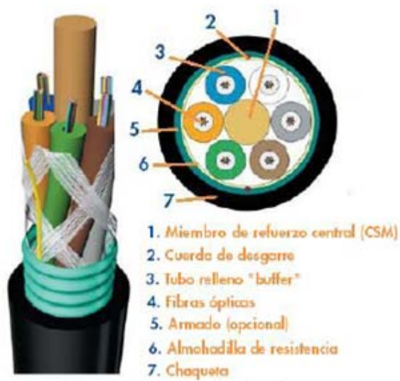
Figura 2.7.- Cable de estructura holgada
