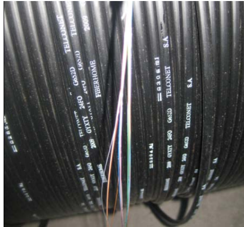
Figura 6.15: Fibra óptica 9/125 monomodo 24 fibras
