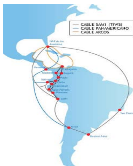
Fig.1.1. Tendido de Fibra Óptica en América
