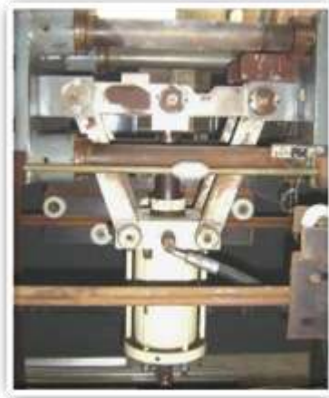
Figura 2.11 Cierre por rodillera simple.
