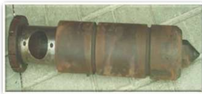
Figura 2.7 Cilindro de inyección con boquilla en la parte delantera.
