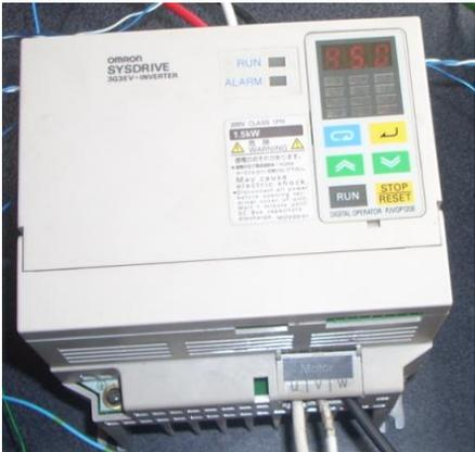
**Figura 6.22 Vista frontal del variador de frecuencia**
