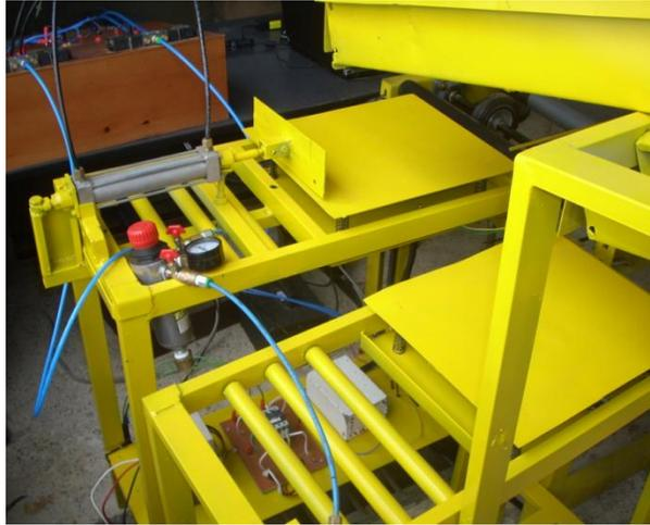
**Figura 6.18** Instalación del pistón y final de carrera
