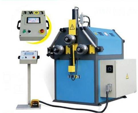
**Figura 4. 5** Dobladora por rodillos CNC.
