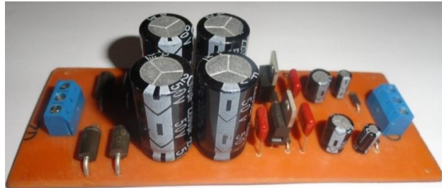
Figura 6.10 Fuente de poder asimétrica de \pm 15V con filtración de ruido. Fuente: Autor
