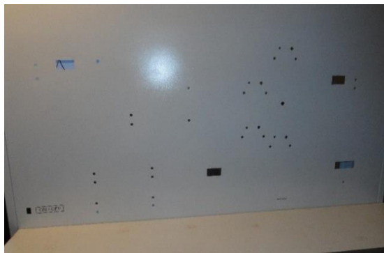
Figura 6.36 Perforación para los elementos electrónicos.
