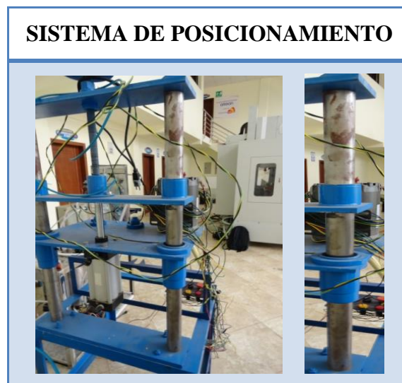
Figura 4.2: Soportes del sistema de posicionamiento
