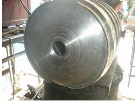
FIGURA 1.- ORIFICIO PARA LA ENTRADA DEL ABONO ORGANICO
