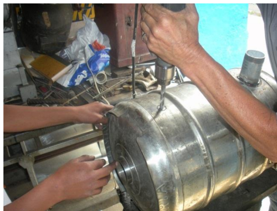
FIGURA 6.- ORIFICIO DEL MANÓMETRO DE PRESIÓN
