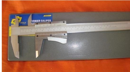
FIGURA 6.32 CALIBRADOR (FUENTE: ELABORADO POR AUTOR)
