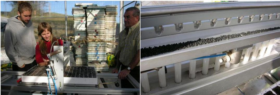
Fig 2.1. *Máquina Neumática para semilleros*<sup>5</sup>
