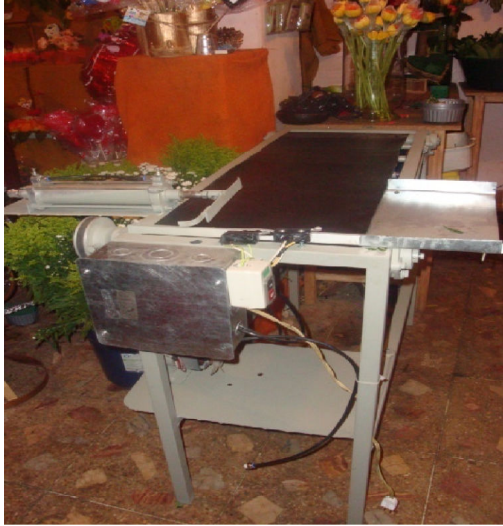
IMAGEN 6.17.- MÁQUINA TRANSPORTADORA DE CAJAS
