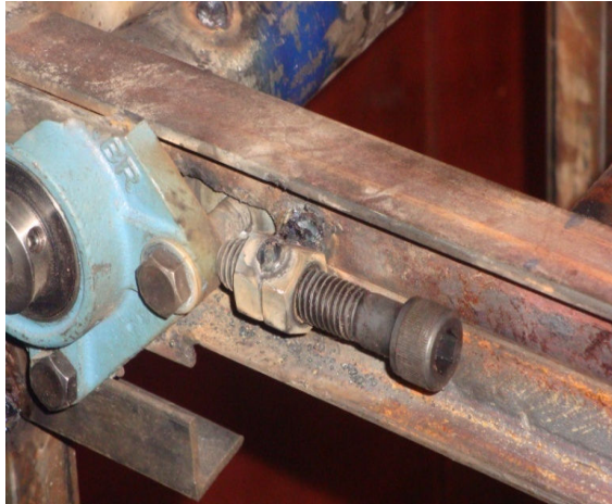
IMAGEN 6.6.- UBICACIÓN DE LOS PERNO TEMPLADOR EN LA CHUMACERA MÓVIL
