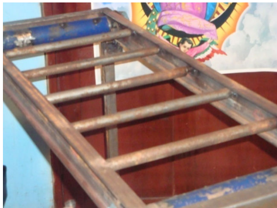
IMAGEN 6.7.- UBICACIÓN DE LOS TUBOS EN LOS PERFILES T
