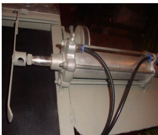
IMAGEN 6.15.- COLOCACIÓN DEL CILINDRO NEUMÁTICO
