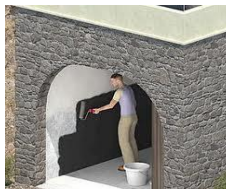
Imagen.VI.6.6.4 Esquema de impermeabilización de Muros
