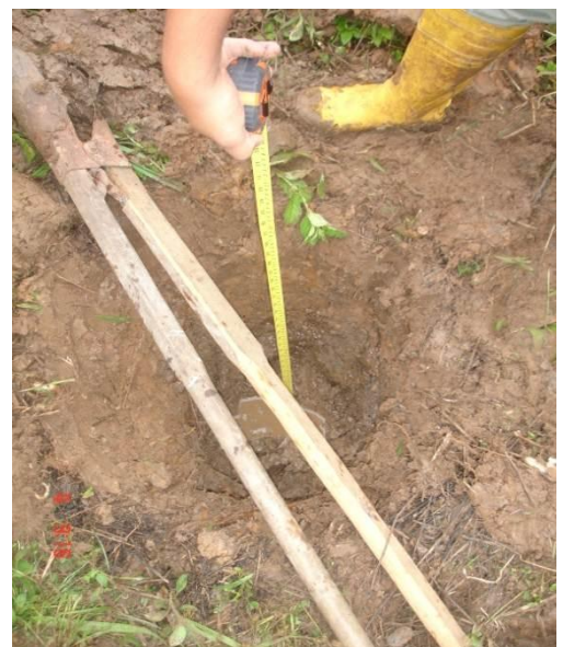
Foto 4. Medición de nivel freático
