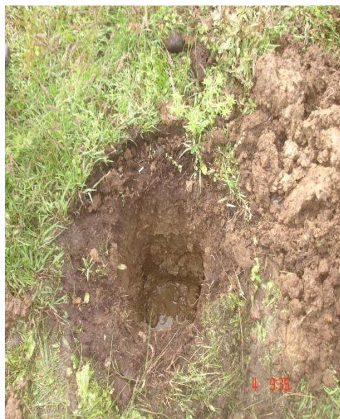
Foto 4. Medición de nivel freático
