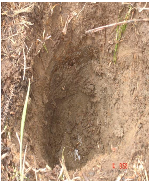
Foto 3. Aparición de agua (nivel freático)
