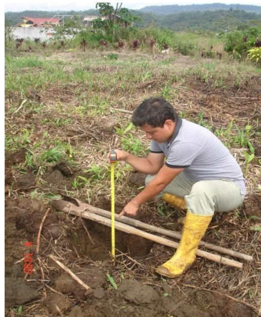
Foto 4. Medición de nivel freático
