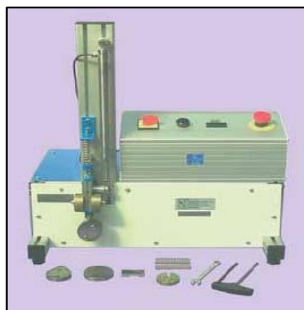
Figura 2.16 Maquina de Análisis de levas Fuente: (Catálogo del Mecanismo. Empresa: EdLabQuip)
