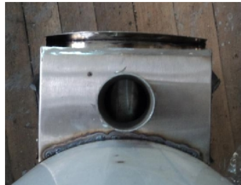
Imagen 6.13.-Soldado de la descarga
