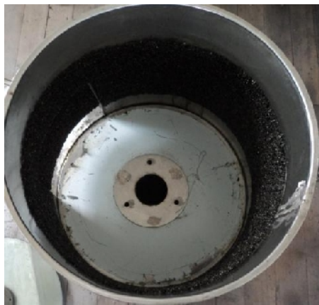
Imagen 6.15.- Lija colocada en el tanque
