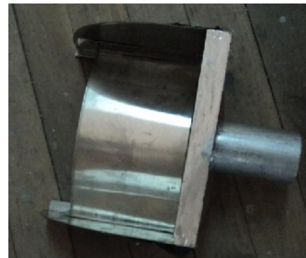
Imagen 6.9.-Boca de descarga armada
