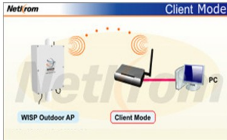
Fig. 3 Access Point modo cliente
