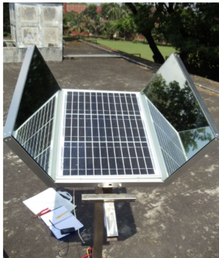
Figura 2.56: Concentrador solar en la ciudad de Dhaka [48]
