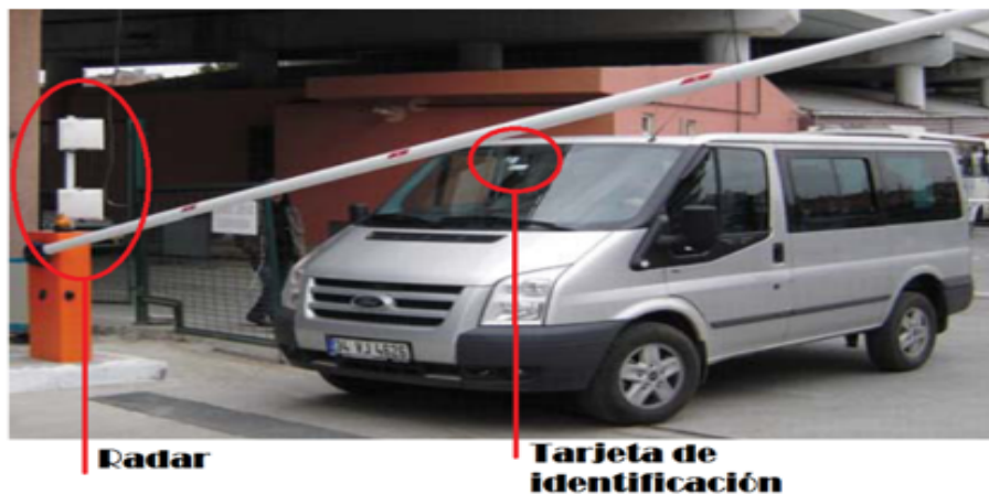
Figura 2.71: Sistema RFID en la detección de vehículos [59]
