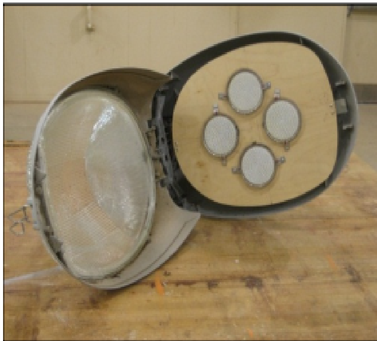
Figura 2.58: Luminarias LED en estructuras tradicionales de iluminación [49].
