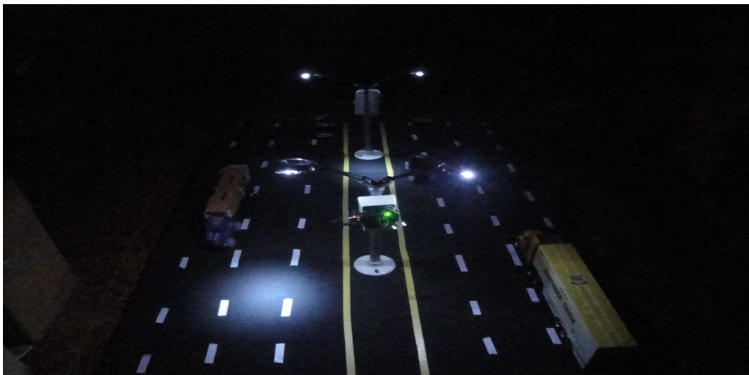
Figura 4.22: Iluminación en ambos sentidos de circulación de la autopista [fuente propia]
