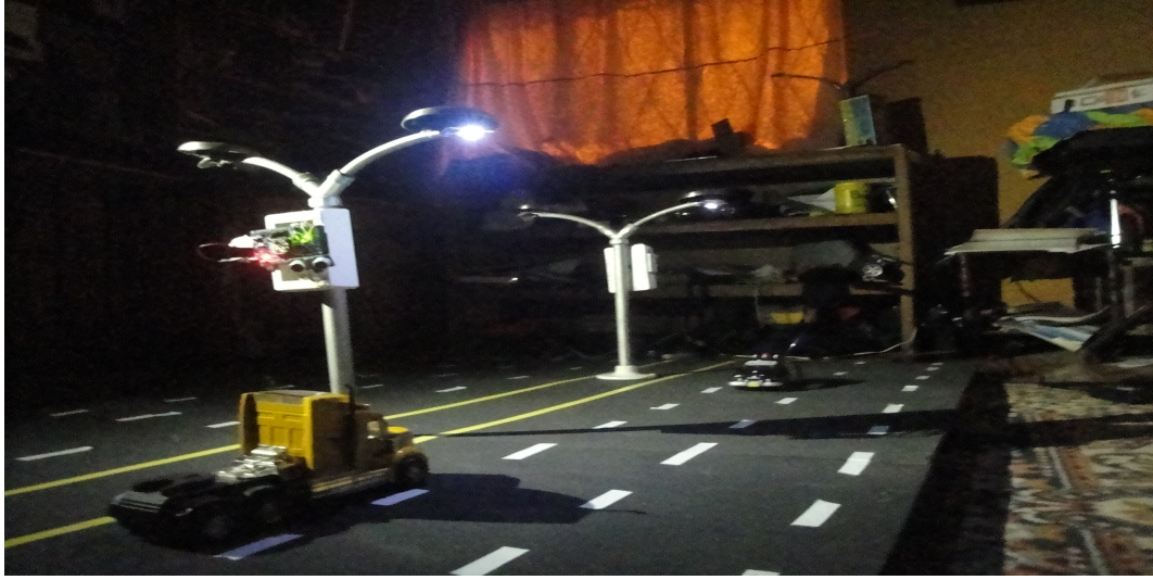
Figura 4.21: Luminarias encendidas en función del flujo vehicular [fuente propia]
