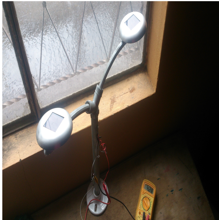
Figura 4.11: Valor de tensión en los paneles fotovoltaicos [fuente propia]
