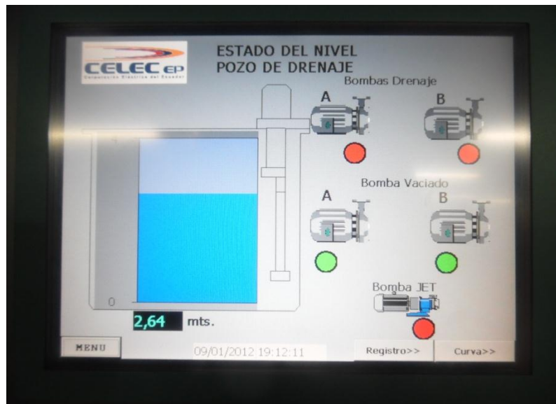
Figura 4.78 Pantalla principal vista por el operador bombas de drenaje y JET encendidas
