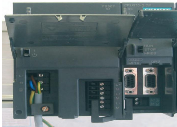
Figura 4.53: Cableado de la fuente de alimentación y la CPU.
