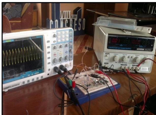
**Figura 4. 31** Circuito Generador de onda triangular
