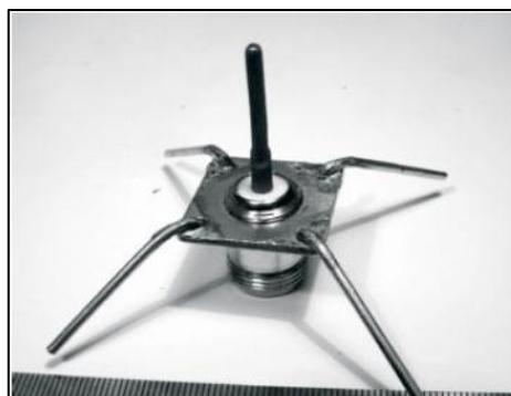
**Figura 2. 10** Monopolo o antena Marconi
