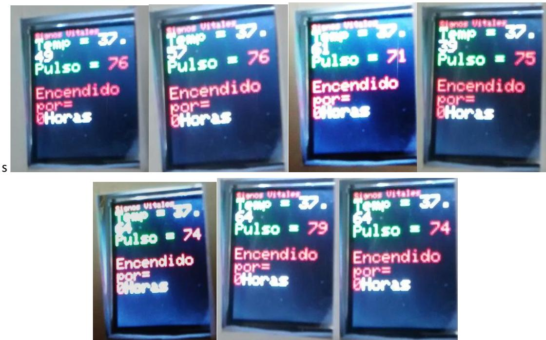
Fig. 4.32 Pruebas de funcionamiento del medidor de signos vitales
