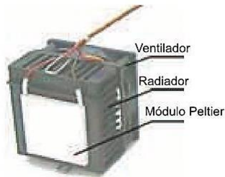
Figura 2-5: Célula Peltier para CPU.
