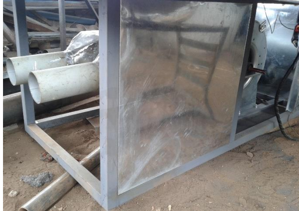
Figura 6-20: Ensamble de ductos + ventilador + forros
