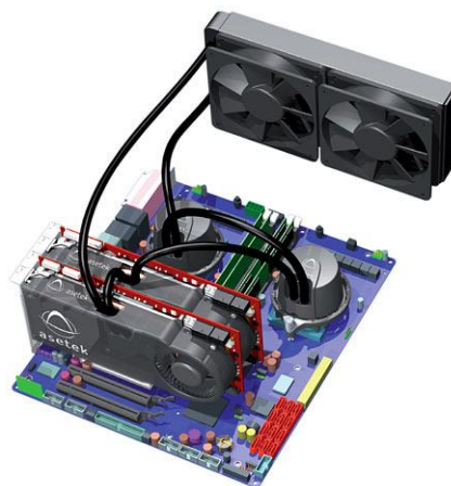
Figura 2-3: Refrigeración por Watercooling
