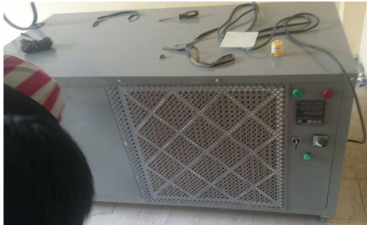
Figura 6-22: Ensamble final de rejillas y filtros
