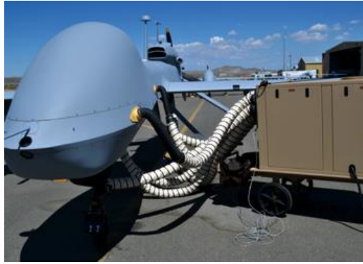
Figura 6-1: DRASH 5-ton ECU refrigeración del Águila Gris
