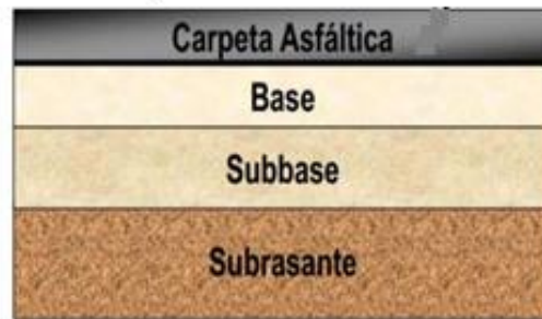
Figura N° 21 Capas de pavimento flexible
