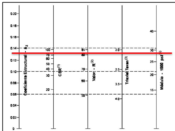
Gráfico N°19. Nomograma para estimar el coeficiente estructural a 2 para Base
